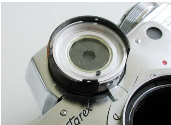
Det runde hus omkring belygningsmålerens øje på Contarex.
