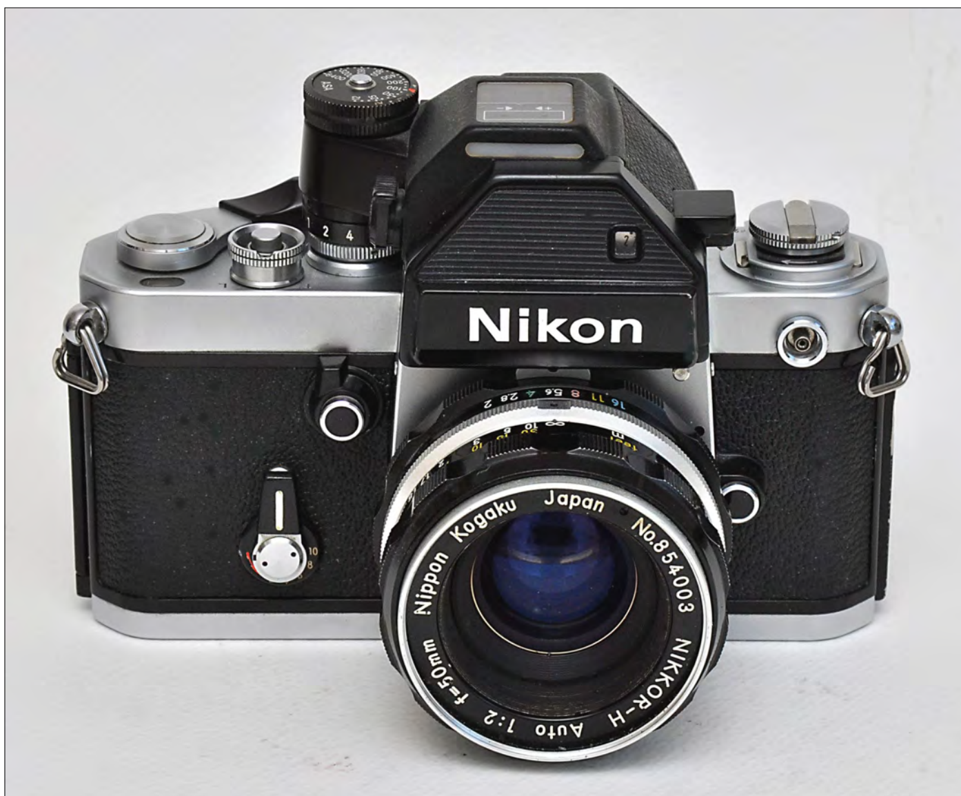
Belysningsmålerens funktion med koblingen til lukkertid og blænde.
