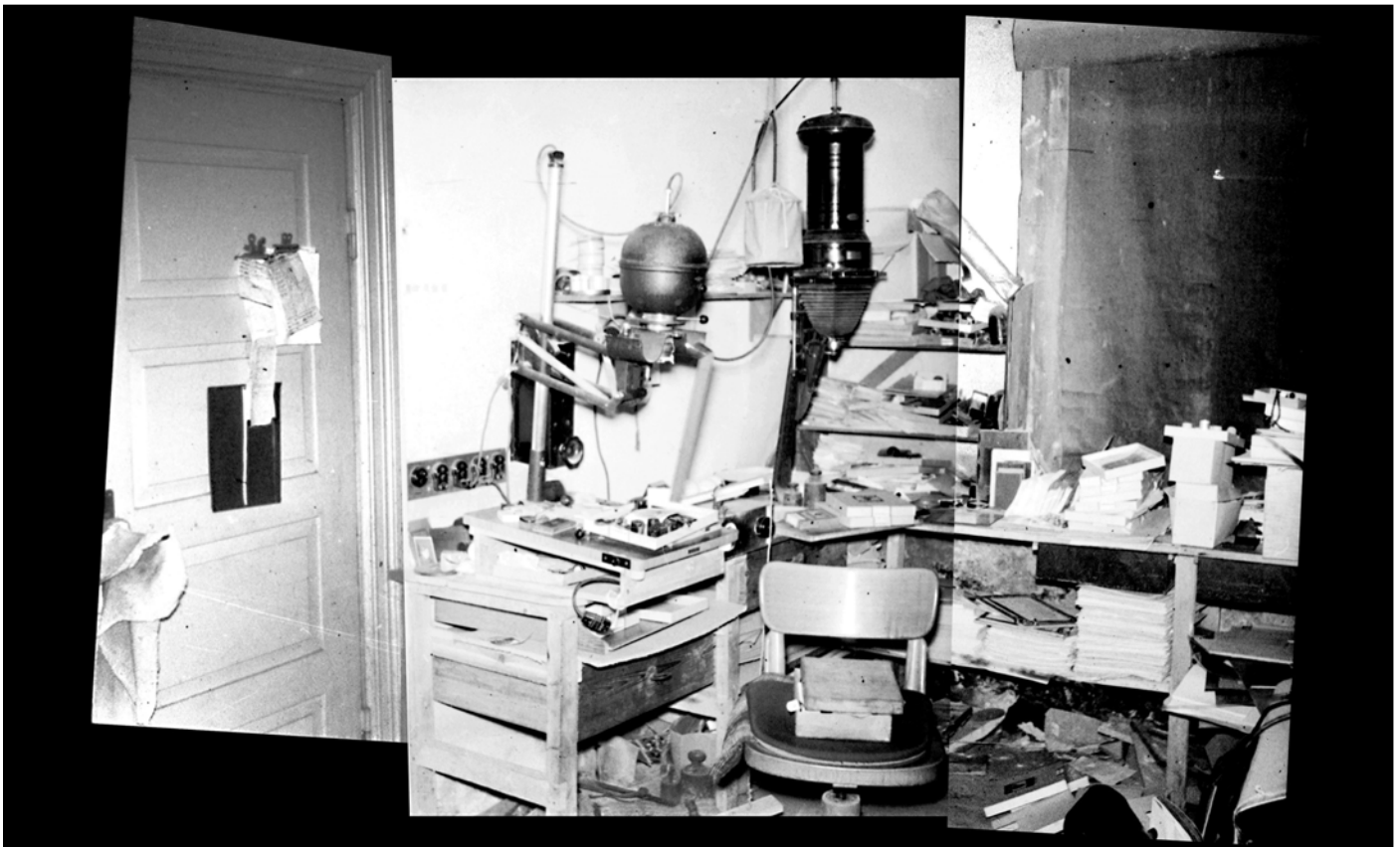
Fig. 16. Thomas Christesens mørkekammer. Forstørrelsesapparater både til glasnegativer (th.) og 35 mm negativfilm (tv.). Sammensatte negativer, Museum Sønderjyllands Mediearkiv.
