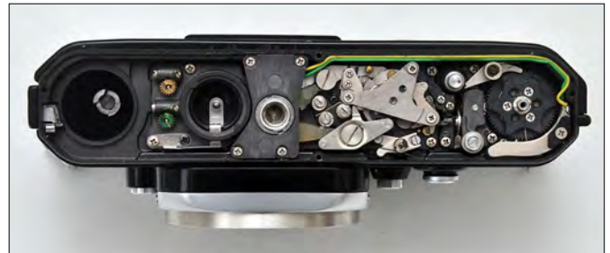
Kameraet med åben bund. Batteribeholderen og afbryderkontakten ses tydeligt.
