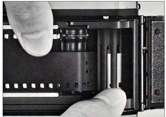
Første type opsamlerspole med 6 slidser.
