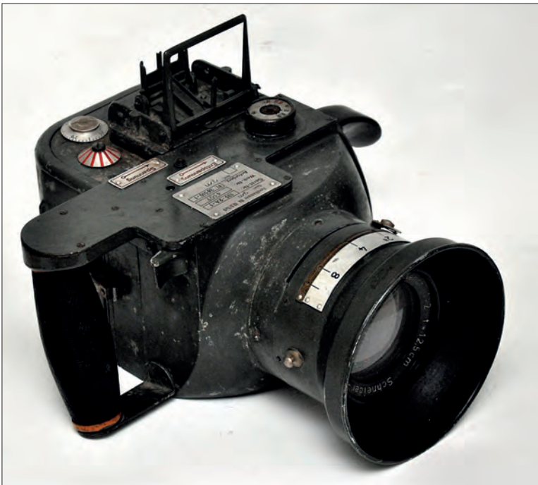
Nederst til højre: Fritz Völk Handkammer Hk 12,5/7x9 med åben filmkammer.
