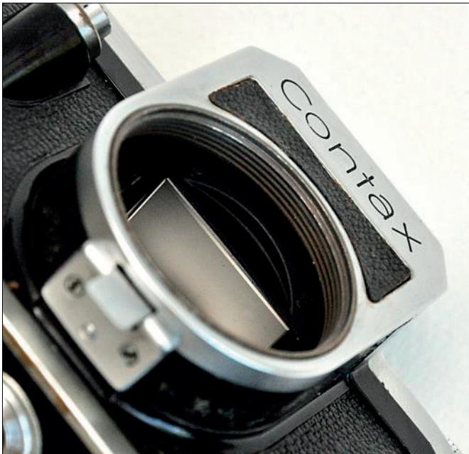
Det mattede prisme set nedefra. De lysslebne kanter fremtræder synligt.
