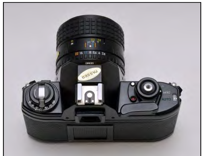
Blikket oppefra afslører de få betjeningslementer. Drejeknappen nøjes med indstillingerne B, M90 og AUTO.
