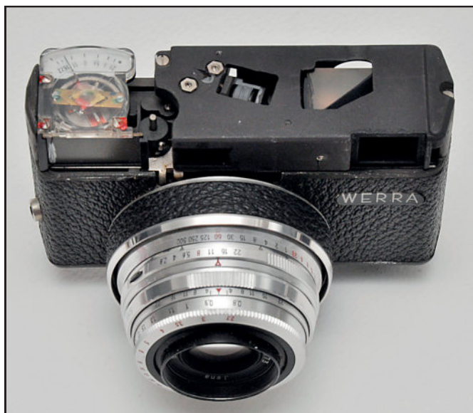
WERRA 4, topdækslet er taget af, afstandsmåleren og belysningsmåleren er tilgængelige til justering.
