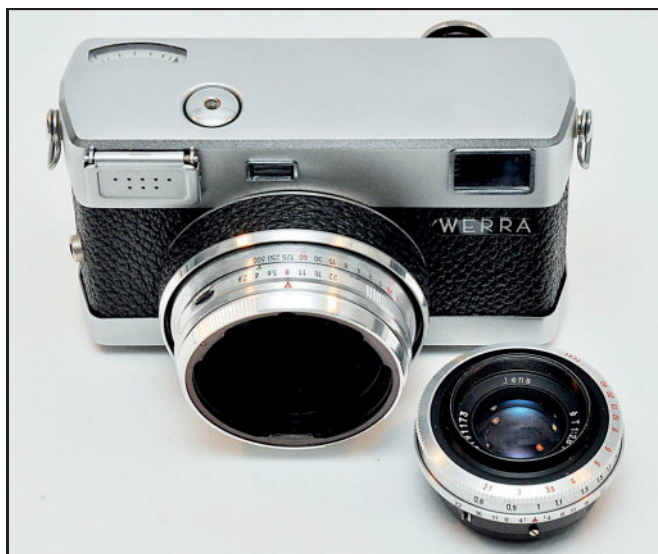
WERRA 4 med koblet afstandsmåler og ukoblet belysningsmåler samt mulighed for objektivskift, 1960.
