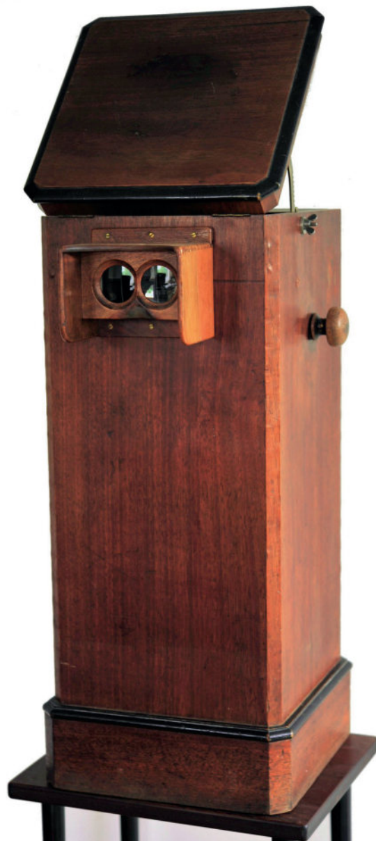
JPA Bordstereoskop. Afstanden mellem de to linser er kun 45 mm og kan ikke justeres. Holderen kan udskiftes, så denne variant har givetvis været til børn. Begge stereoskoper i Helsingør kan justeres.
