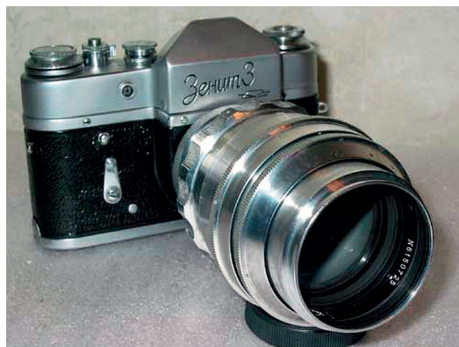
Her er et Zenit-3 kamera med et af de sjældnere Helios-40 f:1,5/85 mm objektiv påmonteret.
