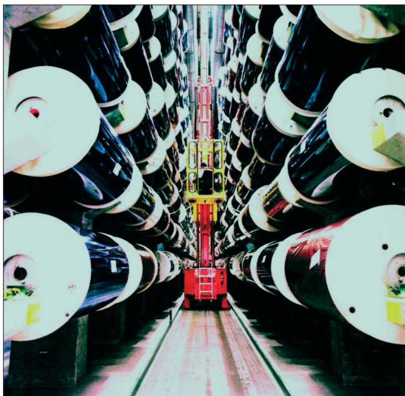
I Antwerpen havde man hos Gevaert tre modningshaller som den viste. Hver af hallerne havde et dobbelt reolsystem opbygget i et støvfrit airconditioneret rum med ca. 25 meter til loftet. Hver reel indeholdt 100 pladser til gyderuller. På en typisk gyderulle lå 600 meter film i en bredde på 140 cm
