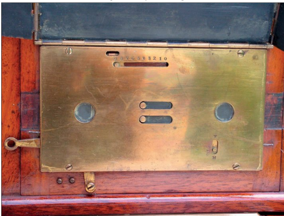
Fast front med mulighed for forskydning
