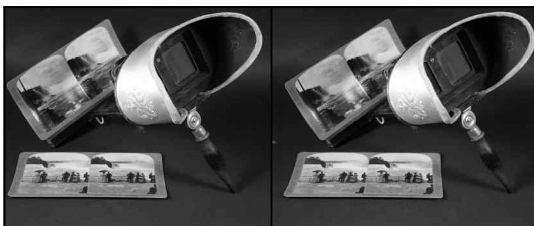
Holmes stereoskop. De to kileformede linser på stereoskopet ovenfor kan udskiftes med en lup til at se f.eks. Forstørrede postkort. Billederne af Niagara Falls er fra Underwood & Underwood
