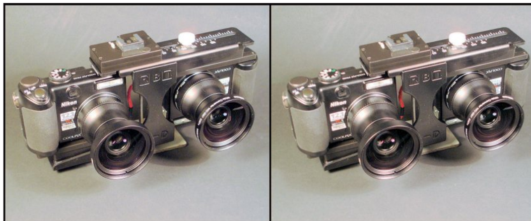
RBT digitalkamera baseret på Nikon coolpix PS100 med 12 megapixel. Kameraet her vist med vidvinkelconverter
