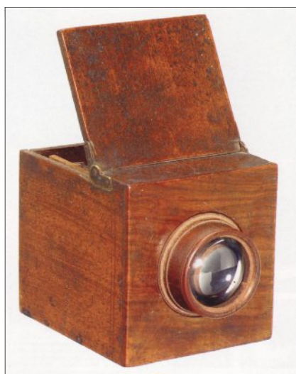
J. Niépce's eksperimentalkamera til optagelse af 'asfaltbilleder', 1825
