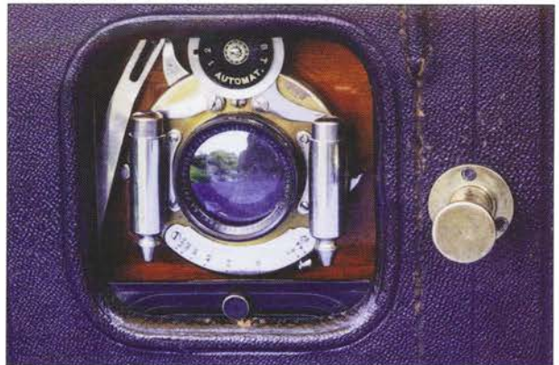
Den pneumatiske lukker ses tydeligt når fronten åbnes.
