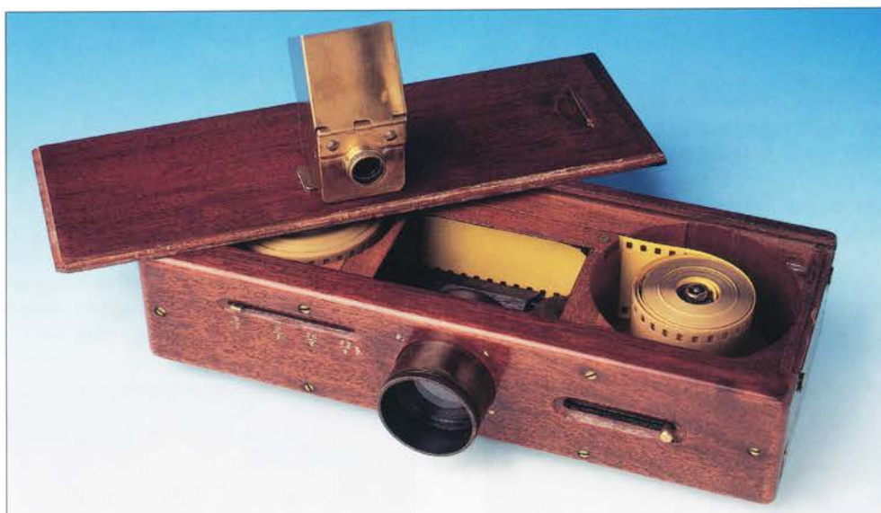
JPA nr.311 småbilledkamera. Format 24x60 mm – til 20 meter 35 mm perforeret kinofilm. (330 billeder) Optik: 2 plankonvekse linser, symmetrisk sammensat i messingindfatning af JPA selv. Blænde: 1/5, 1/8, 1/10, 1/15. Lukker: fast tid 1/100 sek. Fremstillet i 1923.
