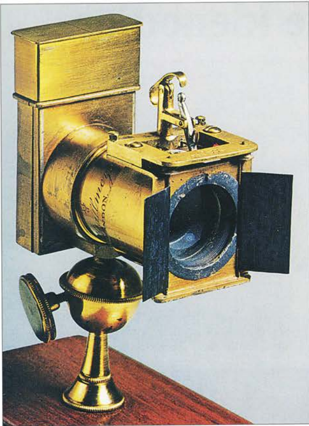
Englænderen Thomas Skaife konstruerede i 1856 en øjeblikklukker til hans Pistolgraph (1860), som havde Petzval objektiv f/2.2 40 mm og f/1.1 til 30x40 mm plader. Sammenklappeligt og betjenes fra et påsat kuglehoved. Miniature mørkekammertelt medfulgte.
