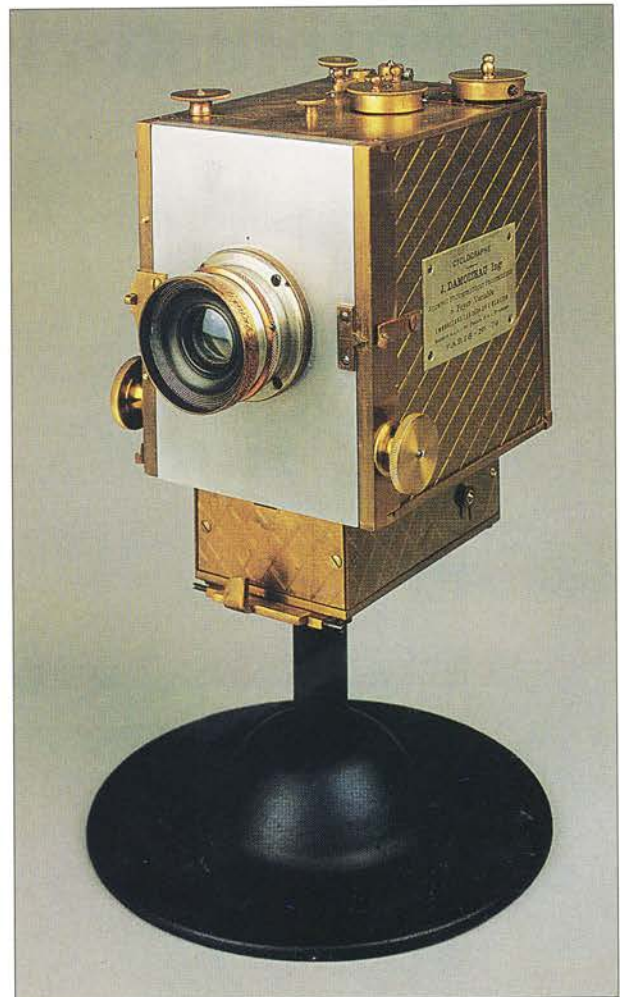
V.J.E. Damoizeau præsenterede i 1896 sin Cyclographe til 178 og 229 mm bredfilm. Et drejeligt urværk ruller synkront filmen frem på indersiden. Optager 360 grader's billeder ved fast blænde.
