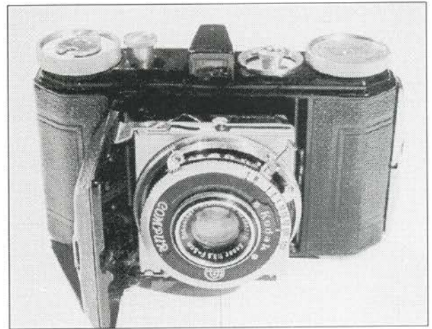
Det første Retina, type 117 med Compur og Schneider Xenar 3,5/5cm. Udløser på lukkeren. Her med en nippel i trådudløserhullet.
