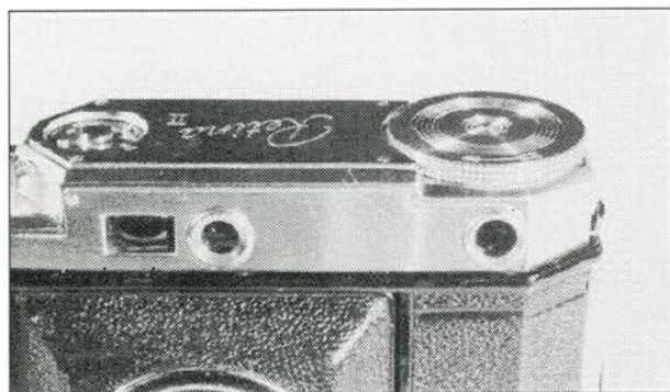
Retina II, type 142 med den første afstandsmåler. Det firkantede vindue er søgeren, de runde er til afstandsmåleren. Man kigger tværs igennem den brede spoleknap.
