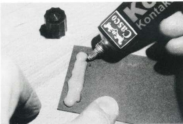
Påfør hele den nødvendige mængde lim i den ene ende.
