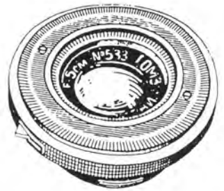
Рис. 81. Объектив «Индустар-10» к фотоаппарату «Спорт»
