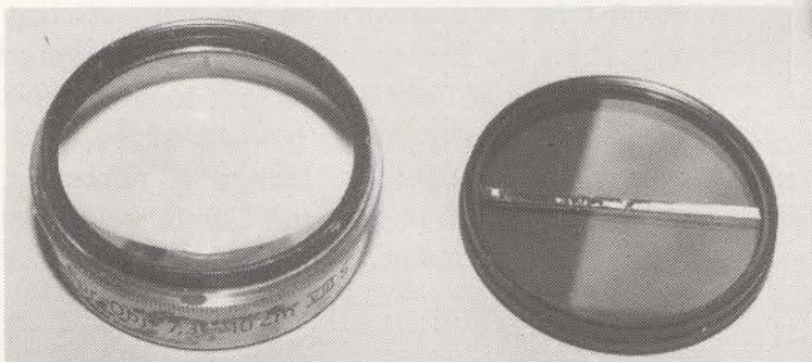
Kondensatorlinse fra VIII's pålimet 55 mm filterring - delt polfilter 55 mm.
