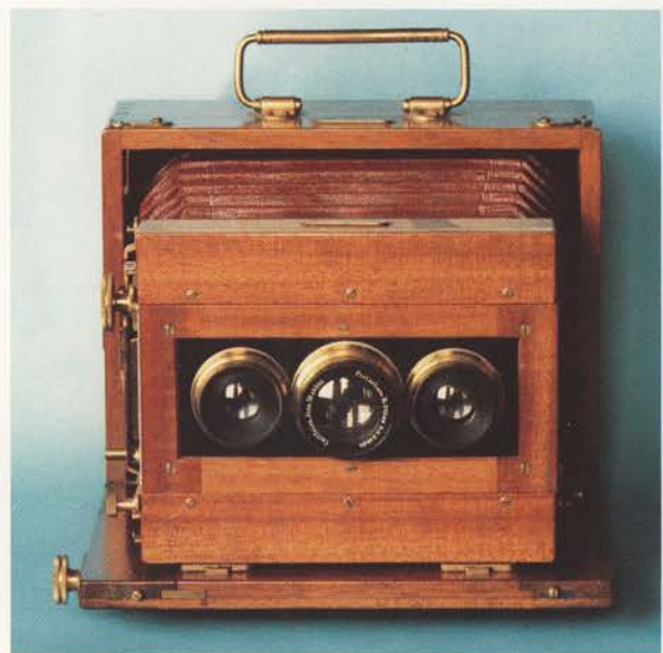
J.P.A. mono- og stereokamera nr. 252. Alt efter hvilke objektiver der afdækkes kan der fotografere såvel mono, som stereo med dette universalkamera.
