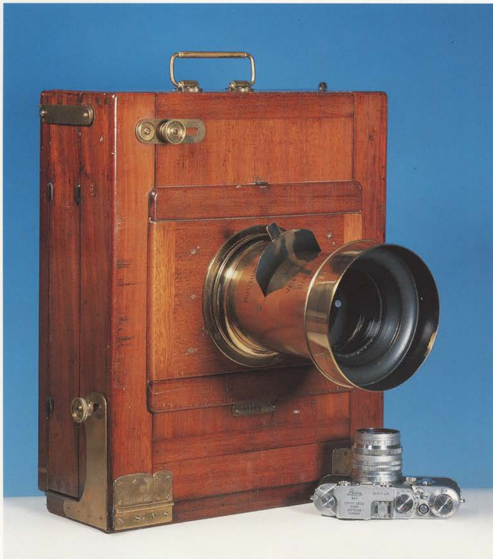
J.P.A.- kamera nr. 120, pladeformat 26x31 cm. Apparatet ses her i sammenklappet stand. Leicaen angiver størrelsesforholdet.
