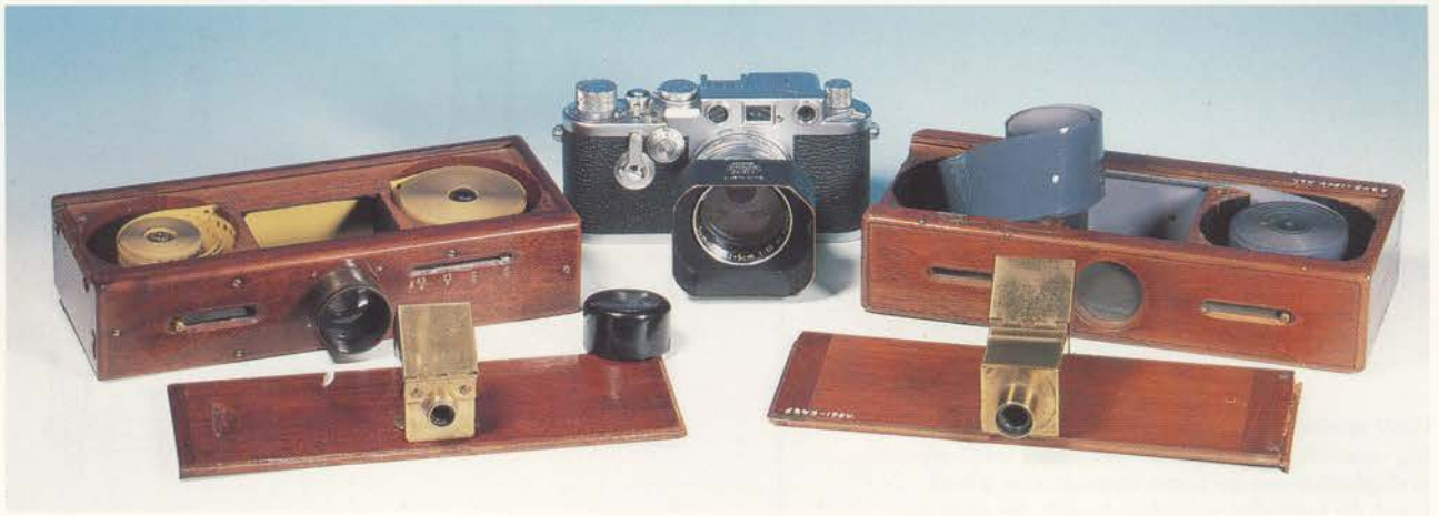
To af Jens Poul Andersens kameraer til 35 mm film. Til venstre nr. 311 beregnet for perforeret kinofilm. Til højre Holger Rosenbergs første kamera af typen nr. 305. Den er konstrueret til uperforeret 35 mm film. Leicaen angiver størrelsesforholdet.
