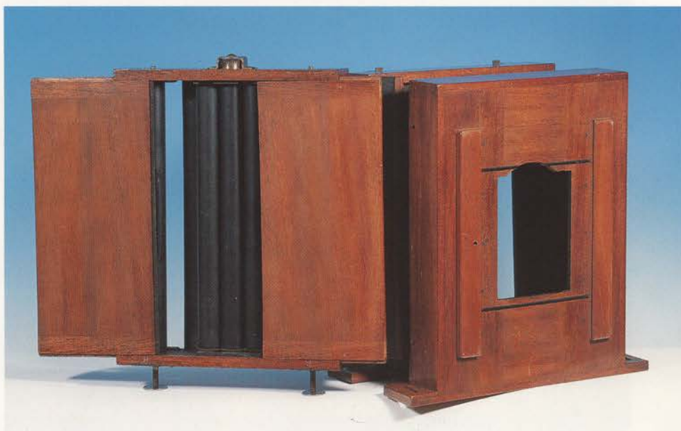
Panorama 360° J.P.A. nr. 235. Kameraet mangler optik og et drejeelement, men har tydelige brugsspor. På Danmarks Fotomuseum findes en optagelse fra Kongens Nytorv, København optaget i 1897. Negativet måler 24,5 x 195 cm.
