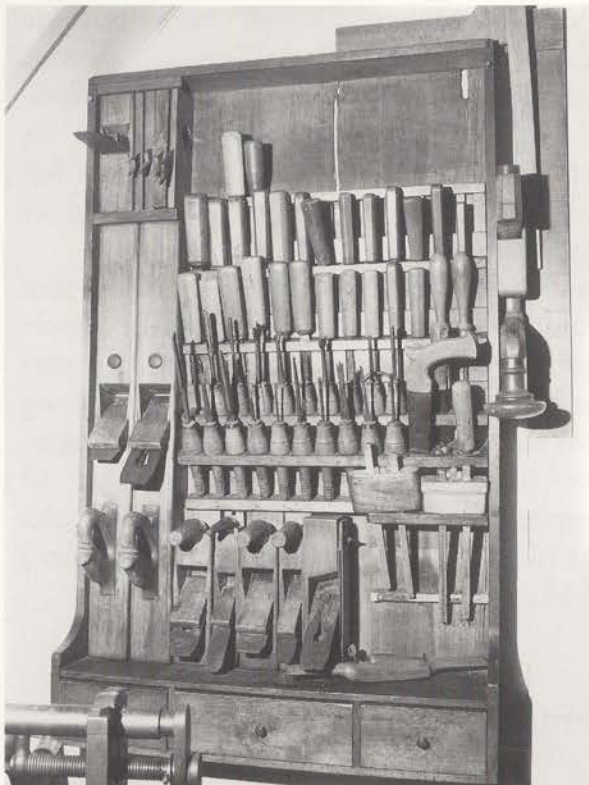
Reol med stort sortiment af værktøj til træbearbejdning. Værktøjsreolen indeholder forskellige høvle, som rubank, slethøvl, pudshøvl og profilhøvl. Desuden træboresving og bor af mange typer, samt et bredt sortiment af stemmejern, opmærkningsværktøj m.v.
