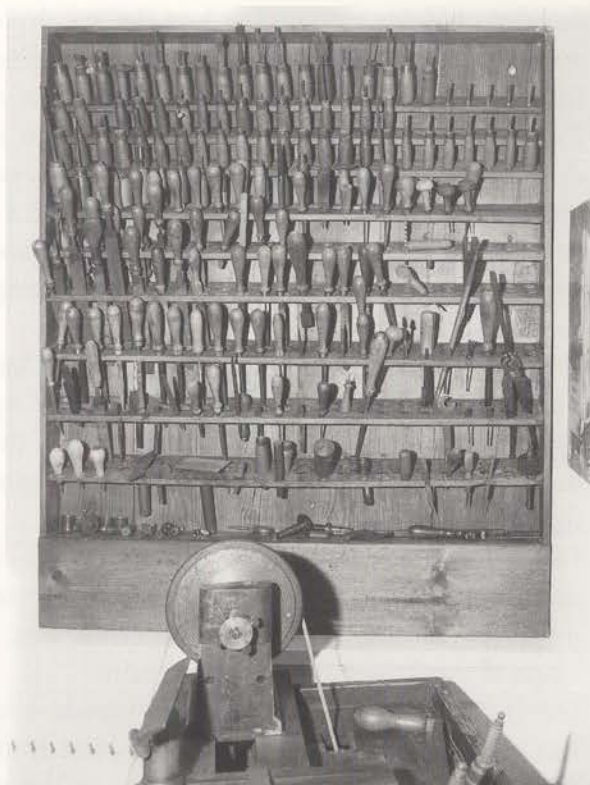
Den anden af de store reoler, hovedsagelig fyldt op med specialværktøj til fremstilling af fotografisk udstyr. I forgrunden ses detalje af drejbænken.
