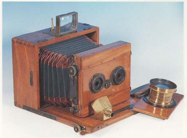
J.P.A. nr. 273. Til dette kamera er der to objektivbrætter - et med monooptik og et med stereo. Pladeformat 12x16½ cm.
