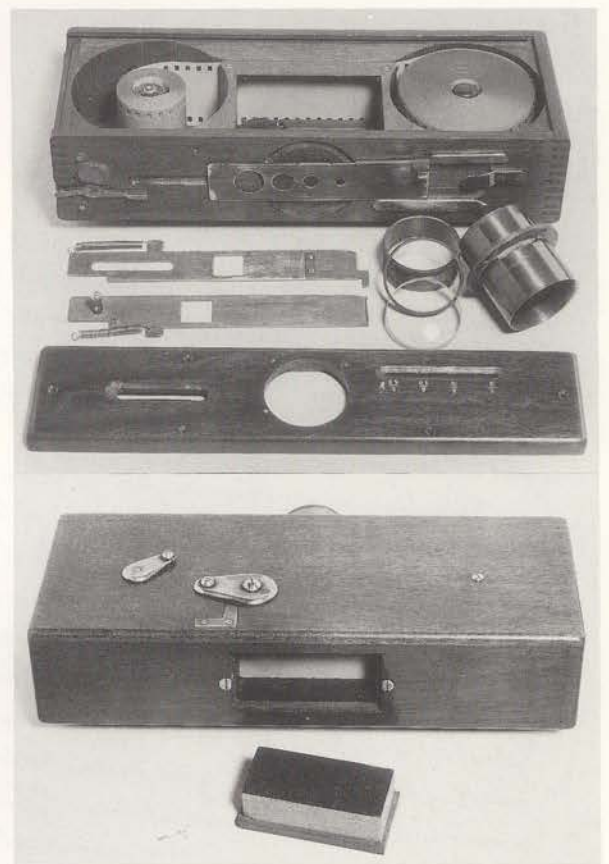
Billedet herover: J.P.A. nr. 311 adskilt. Kameraet er et 100 % J.P.A.-produkt, idet ikke blot kamerahus, men også lukker og optik er fremtillet af snedkeren i Nellerød. Den lille klods bagtil der helt kan tages af, gør det muligt at stille skarpt på selve filmen. Kan kun benyttes til test.
