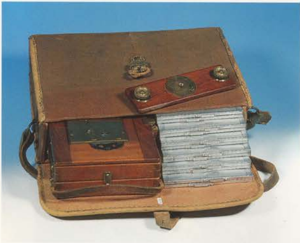
Stereokamera J.P.A. nr. 218. Tilhørende seks trækassetter kan fint rummes i den originale taske tillige med det sammenklappede kamera.
