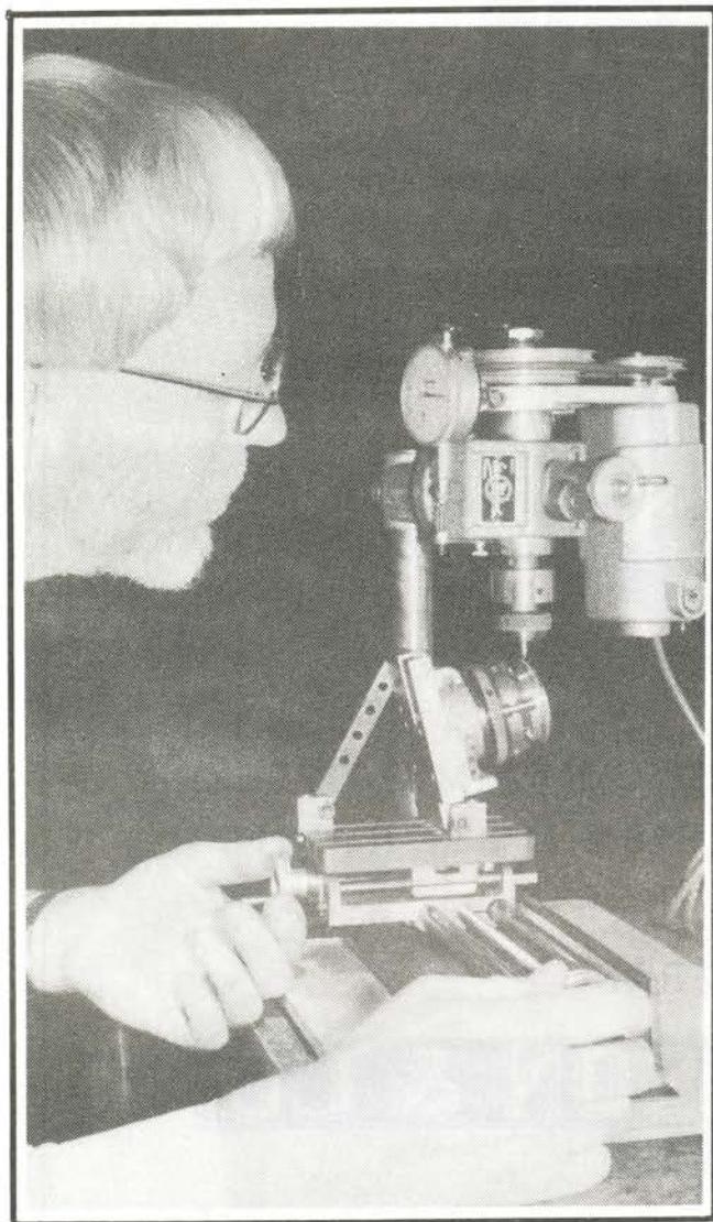
Gravering af blændetal på blænderingen med Emco Unimaten sat op som fræsemaskine.
