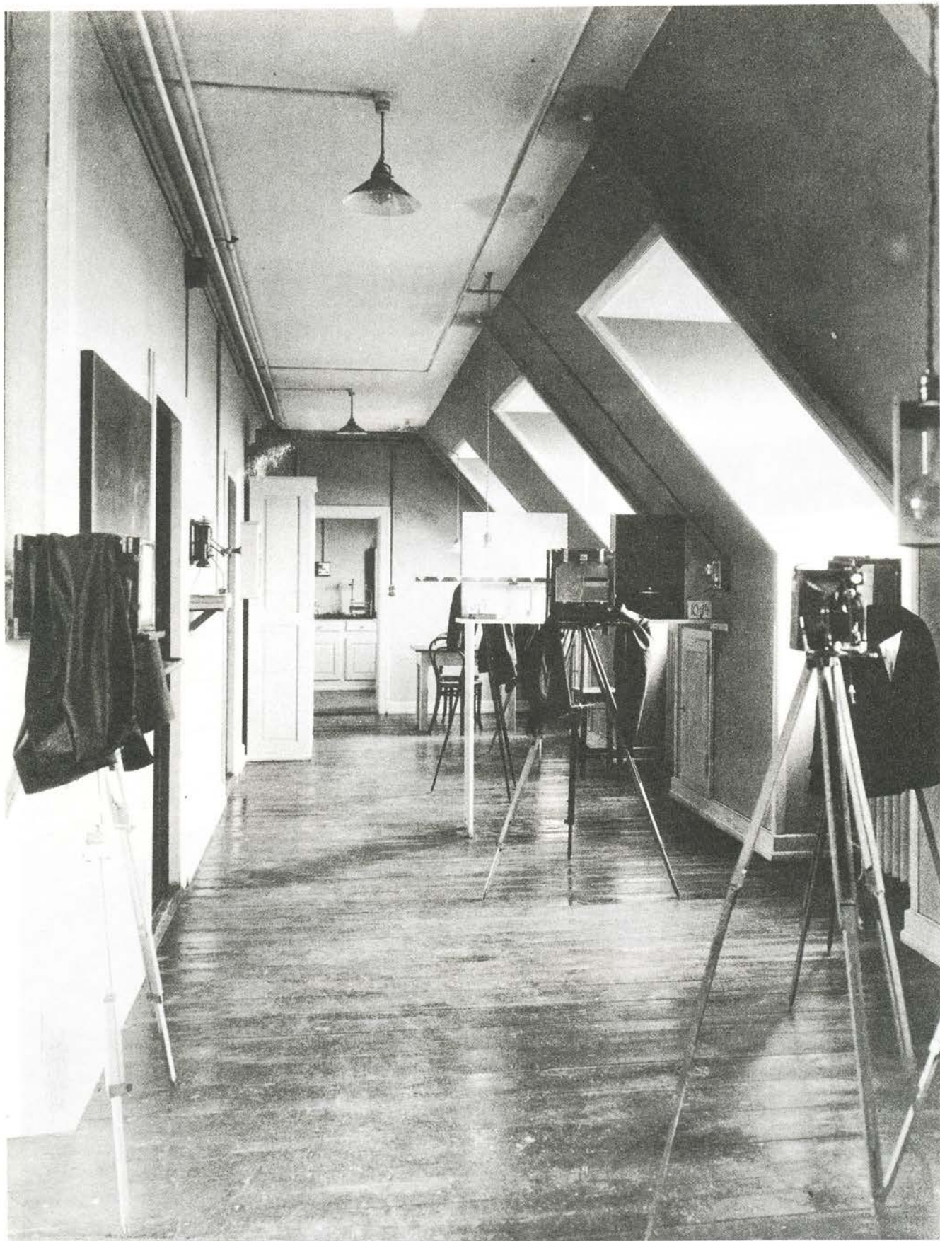
Óptisk laboratorium. En opstilling til måling af objektivers brugbare billedfelt.
