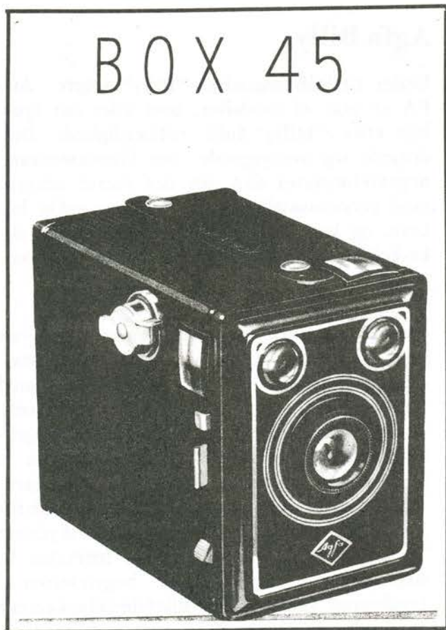
Agfa Box 45, der koster 16 Kr., er Kameraet for Begynderen. Der er ingen Afstands-Indstilling, alt bliver skarpt fra 2,5 m til Uendelig. Agfa Box 45 er helt af Metal, har Robusitbetræk, Støvlinse og Gulfilter. 8 Optagelser paa en 6x9 Film.
