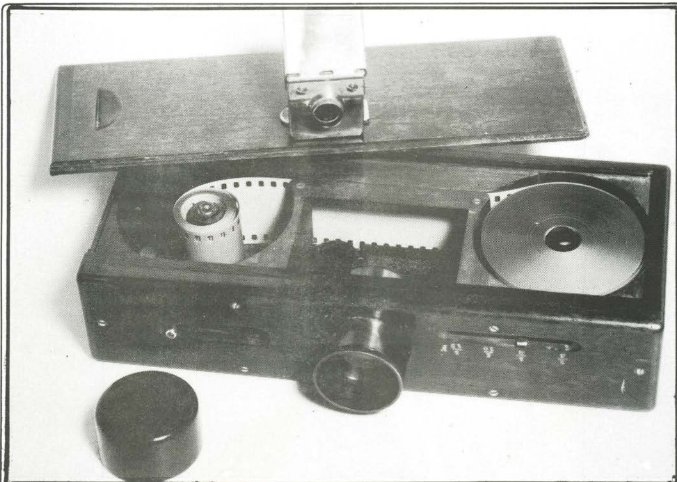
Jens P. Andersens småbilledkamera, 24x50mm kinofilm. 300 optagelser pr. rulle!
